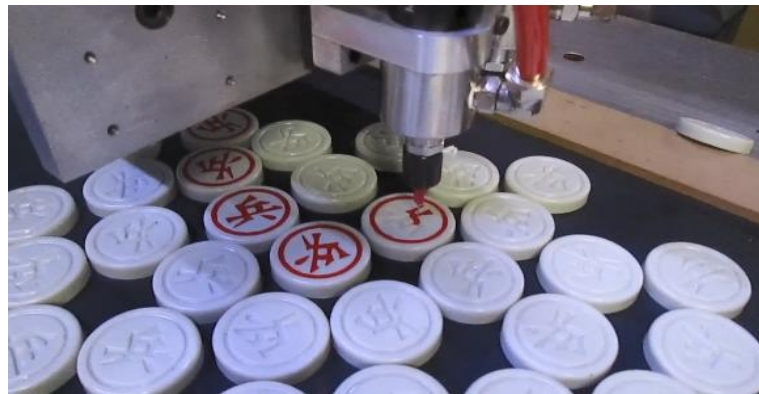
Hình 3. Hệ thống sơn cờ vua tự động (Công ty TNHH TMDV&TBCN Thanh Quốc).
