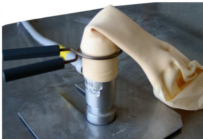
Hình 1: Cổ bóng được lồng vào chén cân
