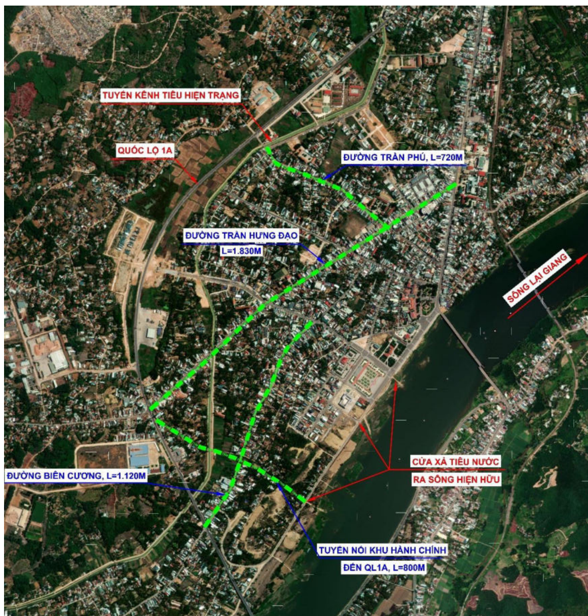
Hình 18: Mặt bằng phạm vi thoát nước mưa khu vực phường Bồng Sơn
