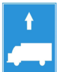
(c) Biển số R.412c “Làn đường dành cho xe ô tô tải”
